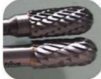
Для резки титановых сплавов могут использоваться борфрезы со специальными зубьями среднего размера.
