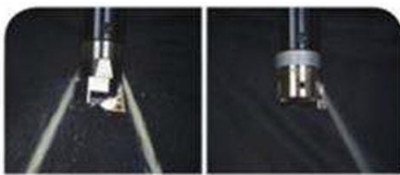
Отвод воды RBH Отвод воды EWN
